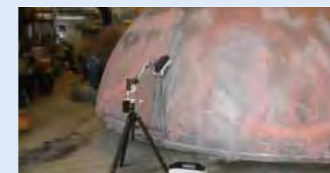
石油精製タンクの溶接、焼鈍効果の確認
